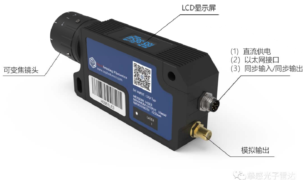
图 2 挚感光子激光测振仪构成
